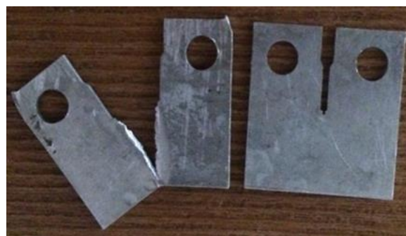
Fig. 10 CT specimens before and after fracture test شکل 10 نمونه‌های کششی فشرده قبل و بعد از آزمون شکست
